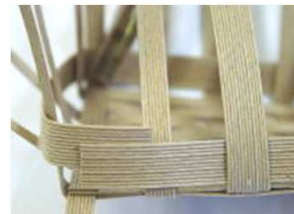
18 一周した⑦を切り口が 外から見えないように 調節し、ボンドで貼る。
